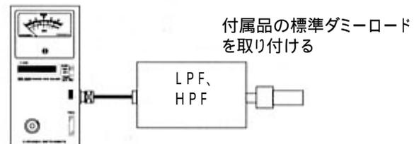
負荷側に付属の50 Ω ダミーロードを接続して測定する。フィルタの場合は周波数特性、チューナの場合は動作周波数範囲などが測定できる。
