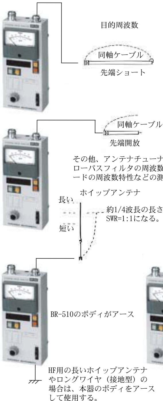
同軸ケーブルの短縮率を含む長さの測定を行う場合は、インピーダンス計で測定します。
