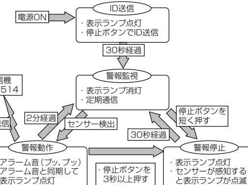
●送信機に振動を与えても、警報動作しない（アラーム音鳴らない。表示ランプ点灯しない）場合は電源を入れ直してください。
