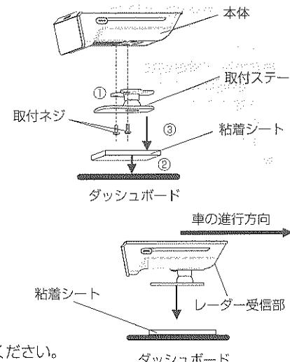
②サンバイザーベースに本体を取り付け、2箇所をネジで締め、しっかりと固定します。
