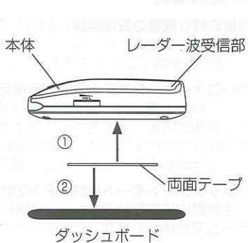
②両面テープのもう一方の面でダッシュボードへ貼り付けます。この時、レーダー波受信部が車の進行方向を向くように、また、地面に水平になるように取付けます。
